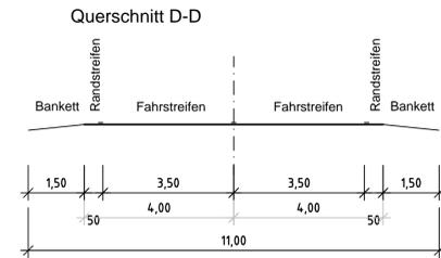
Das Oberflächenwasser wird breitflächig über begrünte Bankette und Böschungen den offenen Entwässerungsmulden bzw. Entwässerungsgräben zugeführt. Durch die breitflächige Ableitung werden Versickerungs- und Reinigungseffekte durch die belebte Bodenzone genutzt.
