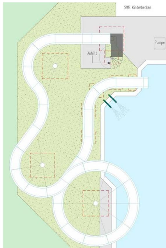
Die Rutschbahn liegt am nördlichen Rand des Nichtschwimmerbeckens und mündet in das Nichtschwimmerbecken. Der Zugang zu der Aufgangstreppe erfolgt über einen ca. 2,15 m breiten Pflasterweg zwischen Schwallwasserbehälter Kinderbecken und Nichtschwimmerbecken um die erste Stahlstütze der Rutsche herum.
