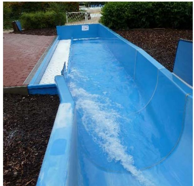
Das **Rutschensofa** in ein bestehendes Becken ist so konzipiert, dass der Benutzer am Ende der Rutsche seitlich in das Becken gleitet.
